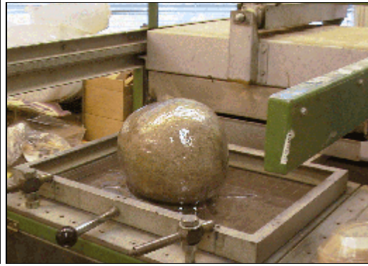
Bild: Rund sten i vacuumformsmaskin.
