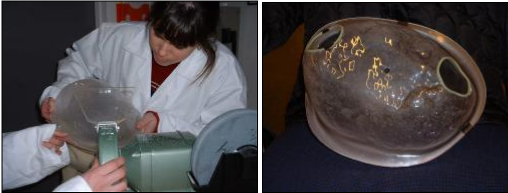
Bild: Slipning av kanter till önskad form. Bild: Undersida utan metall.
